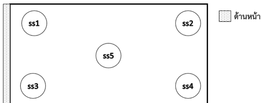
รูปที่ 10 ตำแหน่งการติดตั้งเซนเซอร์วัดอุณหภูมิสำหรับทดสอบการกระจายอุณหภูมิภายในโรงอบแห้ง
