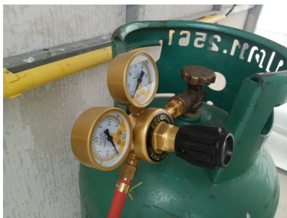
รูปที่ 30 การปรับแรงดันของแก๊สเชื้อเพลิง
