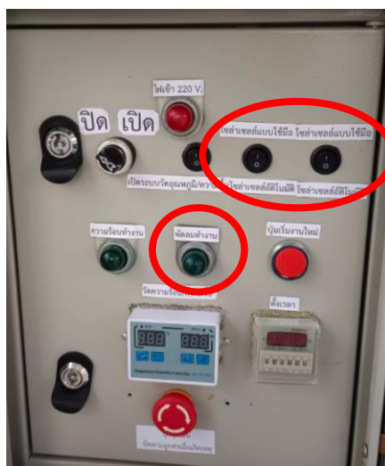
รูปที่ 33 ตำแหน่งปุ่มเปิด-ปิด และหลอดไฟแสดงสถานะการทำงานของการทำงานของการใช้งานพัดลม
