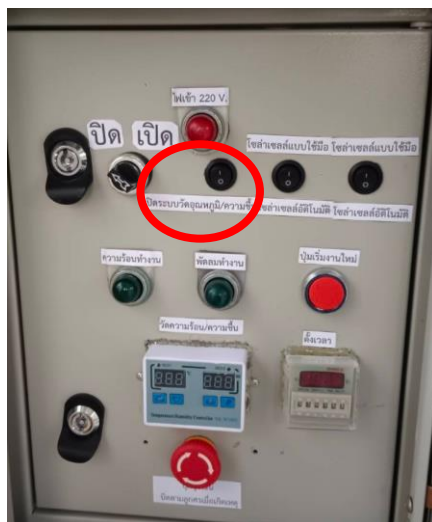
รูปที่ 32 ตำแหน่งปุ่มเปิด-ปิด ของการควบคุมความร้อน และความชื้น
